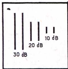
Fig. 18. — Diagramme donnant l'échelle valable en décibels des élongations lues sur les courbes de réponse.
