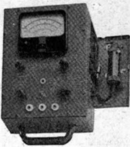
Voltmètre à lampe Métrix avec, à droite, sa sonde H.P.
