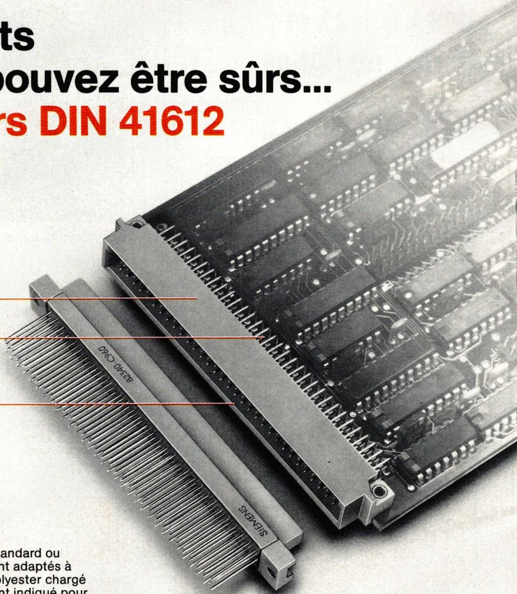
Les connecteurs selon DIN 41612 "standard ou inversés" de Siemens sont idéalement adaptés à vos circuits imprimés : le corps en polyester chargé de fibres de verre est particulièrement indiqué pour un soudage par procédé automatique et les sorties étamées facilitent une excellente soudure.
