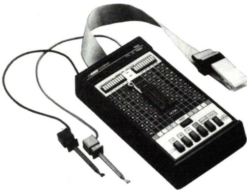
Les Testeurs B + K 550 (famille TTL) et B + K 552 (C.MOS) permettent le contrôle des circuits intégrés sans avoir à dessouder.
