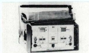
lisé soit lors de la mise en service des liaisons soit lors d'un contrôle d'un répéteur. Sa fonction essentielle consiste à faire varier le niveau du signal numérique à l'entrée de l'équipement à tester.
