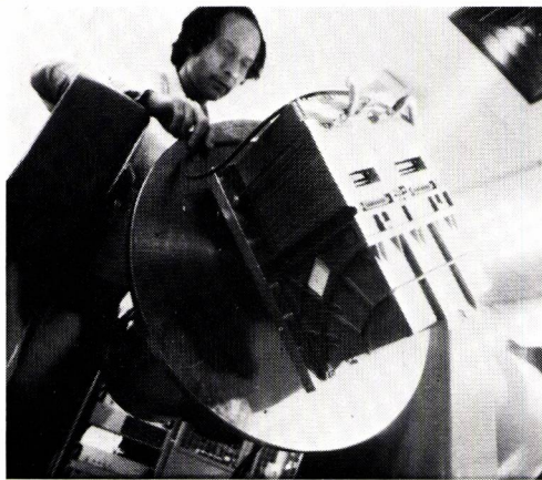
Fig. 5: Les moyens d'essais des centrales sont complexes et comprennent généralement une table à deux ou trois axes performante. Ces tables sont commandées par un ordinateur qui assure également l'acquisition et le traitement des mesures.
