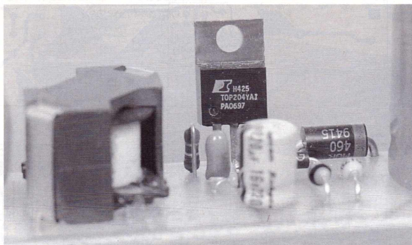
■ Avec le TOPSWITCH, tout est intégré dans le boîtier TO220.
