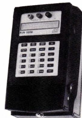
simuler les mêmes thermocouples et sondes à résistance. Le modèle PN 5209 possède, parmi ces fonctions, celles relatives aux contrôles des températures ; le modèle JN 5305, celles relatives aux contrôles des boucles de régulation (0-10 V, 4-20 mA...).
