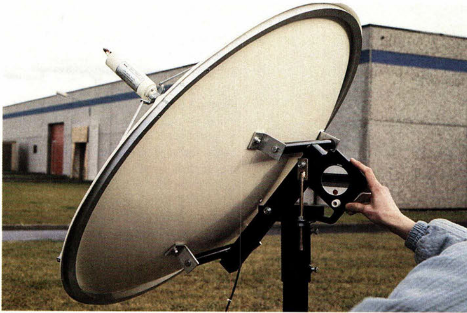
Figure 3 Monture AZ/EL. Vérification de l'élévation à l'inclinomètre.
