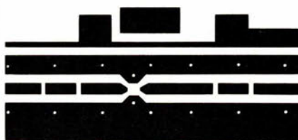
Figure 5 - Circuit imprimé ampli 1 étage. Attention les composants sont soudés en surface. Les trous matérialisent les traversées de masse.
