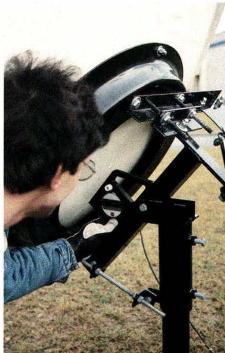
Figure 4 Monture polaire. Vérification de l'inclinaison de l'axe polaire
