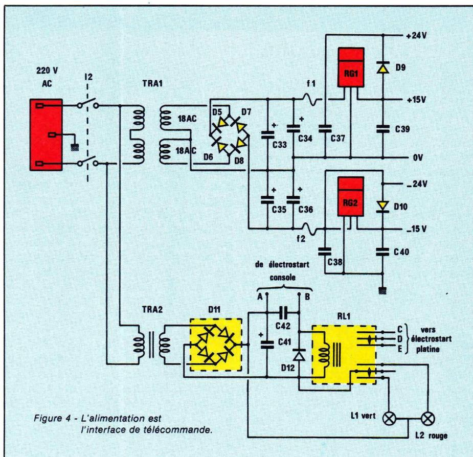
Figure 4 - L'alimentation est l'interface de télécommande.
