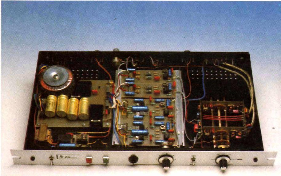
Ceci fait, il faut souder des pattes de résistances d'au moins 1,5 cm dans chacun des œillets restant en place, afin de permettre les liaisons avec les cartes identiques AC<sub>2</sub> et AC<sub>2</sub>'. Veillez à ne pas faire couler de
