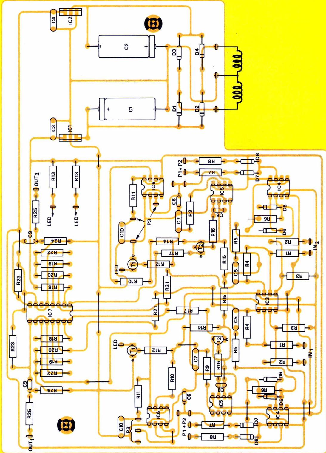
Figure 7 - Tacé du circuit imprimé.
