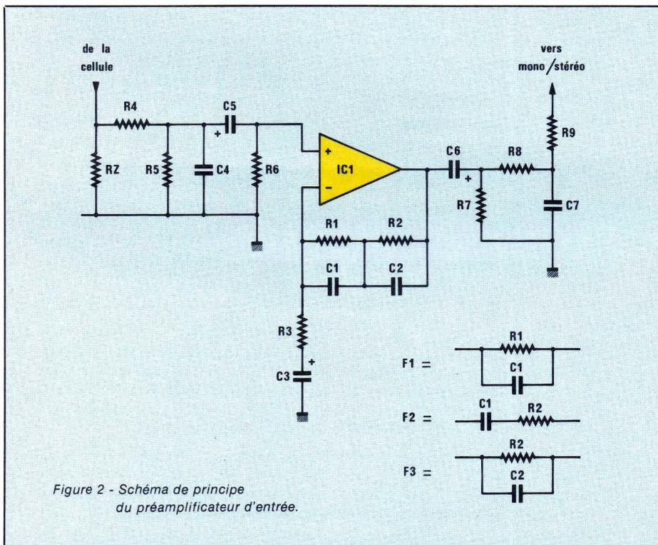
Figure 2 - Schéma de principe du préamplificateur d'entrée.
