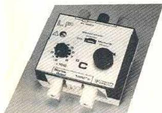
En outre le linéarisateur LP permet de simuler un capteur à résistance platine 100  $\Omega$  à 0 °C et permet de vérifier l'étalonnage de tous les récepteurs de mesure (régulateur, enregistreur...) utilisés avec ce type de capteur. La lecture de la température du capteur simulé s'effectue en °C sur le multimètre.
