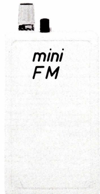
108 MHz et que la fonction soit parfaitement linéaire. Si la tension de commande est limitée à 9 V il sera impossible de recevoir les stations dont la porteuse est supérieure à 103 MHz.
