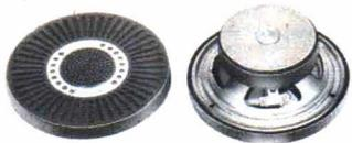
Réf. **ES-81** - H.P. encastrable, d. 16 cm, membrane renforcée, à suspension souple, avec cône d'aiguës, réponse en fréq. 40 à 16 000 Hz, puissance max. admissible **20 WATTS** musicaux, impéd. 4 ohms, profondeur d'encast. 5 cm, grille décor amovible, cordon 3,5 m.
