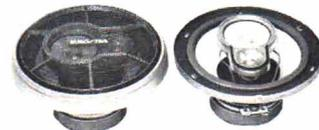
Réf. **ES-85** - H.P. 3 voies (woofer 16 cm à aimant céramique, médium et tweeter axiaux, filtre capacitif), puissance max. admissible **30 WATTS** music., impédance 4 ohms, profond. d'encastrement 63 mm, grille décor amovible, cordon 4 m.
