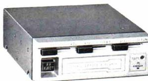
Lecteur stéréo pouvant recevoir tous types de cassettes (support magnétique Fe ou Cr), pleurage < 0,3 %, puissance totale **12 WATTS** (2 x 6 W), contrôle de volume, tonalité, balance stéréo, touche combinée AVANCE rapide et EJECTION cassette, auto-stop fin de bande, sorties H.P. impéd. 4 ohms, alim. 12 volts (- à la masse), L. 120. H. 45. P. 135 mm en boîtier ..... 195.00 + port et embal. 15.00
