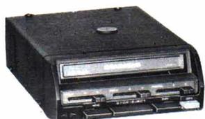
Permet d'écouter en suivant les 2 enregistrements d'une cassette, sans avoir à éjecter ni retourner la cassette, sélecteur de pistes (1-3 ou 2-4), touches (blocables) d'AVANCE et RETOUR rapide de la bande, touche stop/ejection cassette, contrôle de volume, tonalité, balance stéréo, puiss. totale **12 WATTS** (2 x 6 W), sorties H.P. 4 à 8 ohms, alim. 12 volts (- à la masse), L. 123. H. 52. P. 190 mm.
