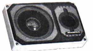
Dimensions: 214 x 137 x 44 de haut, de conception **extra-plate**, ne nécessite ni découpe, ni encastrement, s'installe « plaquée » sur toute surface adéquate - Equipement: 1 woofer 119 mm, 1 tweeter 36 mm, filtre capacitif, puissance max. admissible **30 WATTS** music., impéd. 4 ohms, cordon 3 m.
