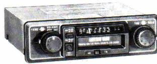
Récepteur **GO - PO - FM** mono et stéréo (MPX) avec C.A.F., voyant d'émissions stéréo — Lecteur toutes cassettes stéréo (bandes Fe ou Cr), touche combinée AVANCE rapide de la bande et EJECTION cassette, auto-stop fin de bande, commandes de volume, tonalité, balance stéréo, puissance tot. 12 WATTS (2 x 6 W), impéd. H.P. 4 à 8 ohms, alim. 12 V (— à la masse), L. 180, H. 48, P. 160 mm.
