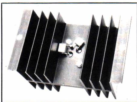
du mica de graisse ainsi que la semelle de IC<sub>1</sub> : vu la puissance à évacuer, ce point doit être particulièrement soigné.
