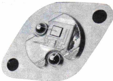
gulateur 78 M 05). Quelques traces sur le substrat thermoconducteur constituent les résistances (dont celle de mesure d'intensité). Enfin, ce substrat est en contact thermique avec la semelle du TO 3 par une couche d'oxyde de béryllium pour une meilleure évacuation de la chaleur.
