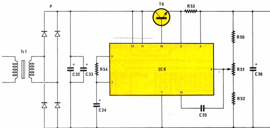
Figure 29 : schéma de l'alimentation 10 V.
