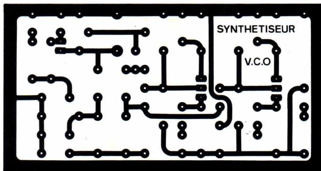
Figure 22 : tracé des pistes du VCO à composants discrets.
