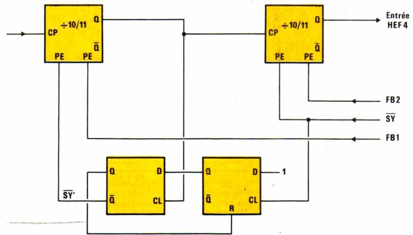
Figure 13 : Régénération du signal SY par 2 prédiviseurs ECL.
