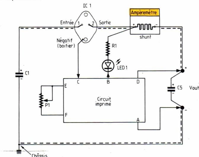
Figure 6 : Plan de câblage des alimentations CB. (Les liaisons doublées en pointillé sont à effectuer en fil de fort diamètre).
