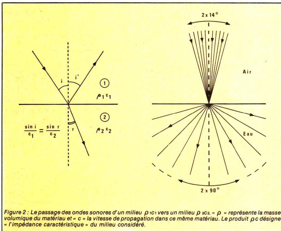
Figure 2 : Le passage des ondes sonores d'un milieu  $\rho_1 c_1$  vers un milieu  $\rho_2 c_2$ . «  $\rho$  » représente la masse volumique du matériau et «  $c$  » la vitesse de propagation dans ce même matériau. Le produit  $\rho c$  désigne « l'impédance caractéristique » du milieu considéré.
