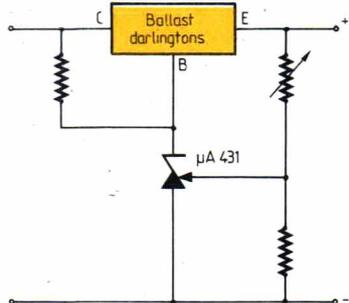
Figure 1d : Pilotage par zener programmable.
