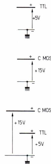
Figure 7b : Alimentation pour la logique. Exemple de changement de technologie (CMOS → TTL ou TTL → CMOS) Alimentation hybride.
