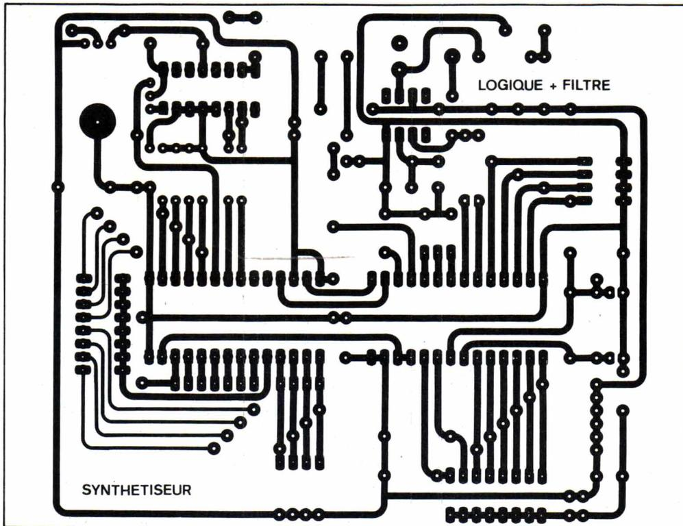
Figure 27 : circuit imprimé du synthétiseur.
