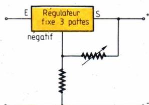
Figure 1c : Régulateur « 3 broches » ajusté.
