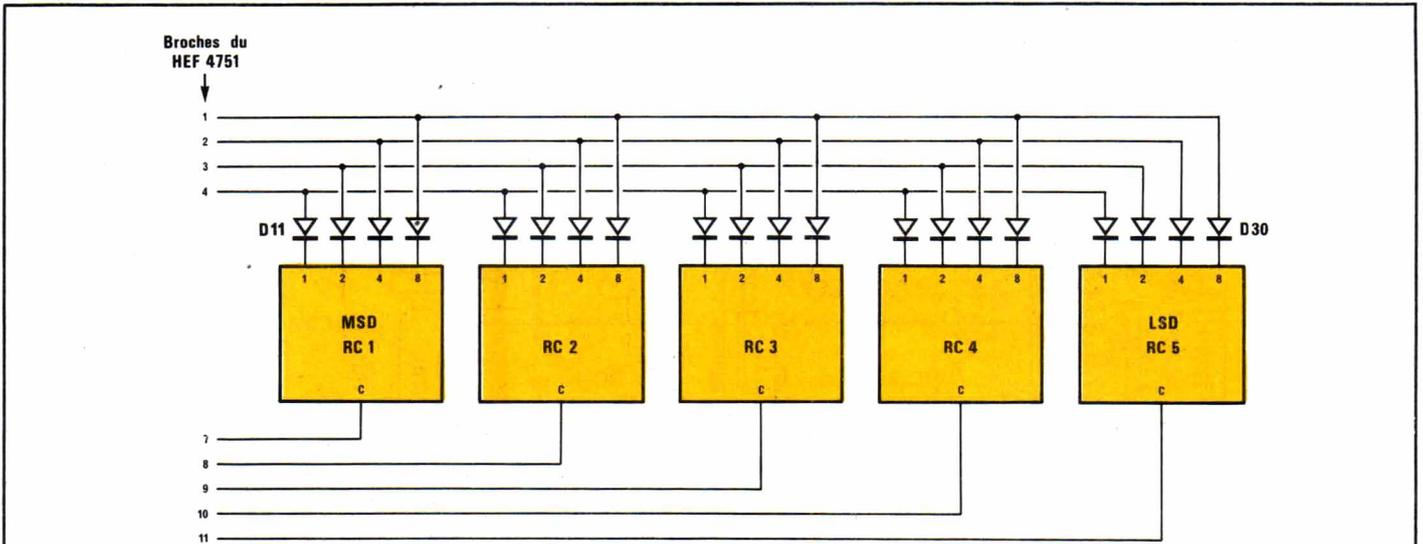
Figure 26 : câblage des roues codées. Interconnexion avec le circuit HEF 4751.
