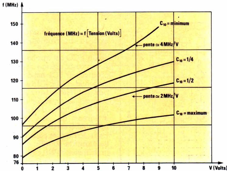
Figure 20 :  $f$  en MHz =  $f$  [tension (volts)] courbe caractéristique du VCO. L bobinée sur une forme de 5 mm.
