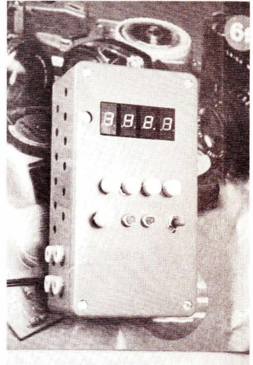
*Photo 5 : Les afficheurs à LED et les circuits TTL, même en version LS, chauffent suffisamment pour justifier une aération que l'on ne devra en aucun cas négliger, même pour des raisons d'esthétique.*
