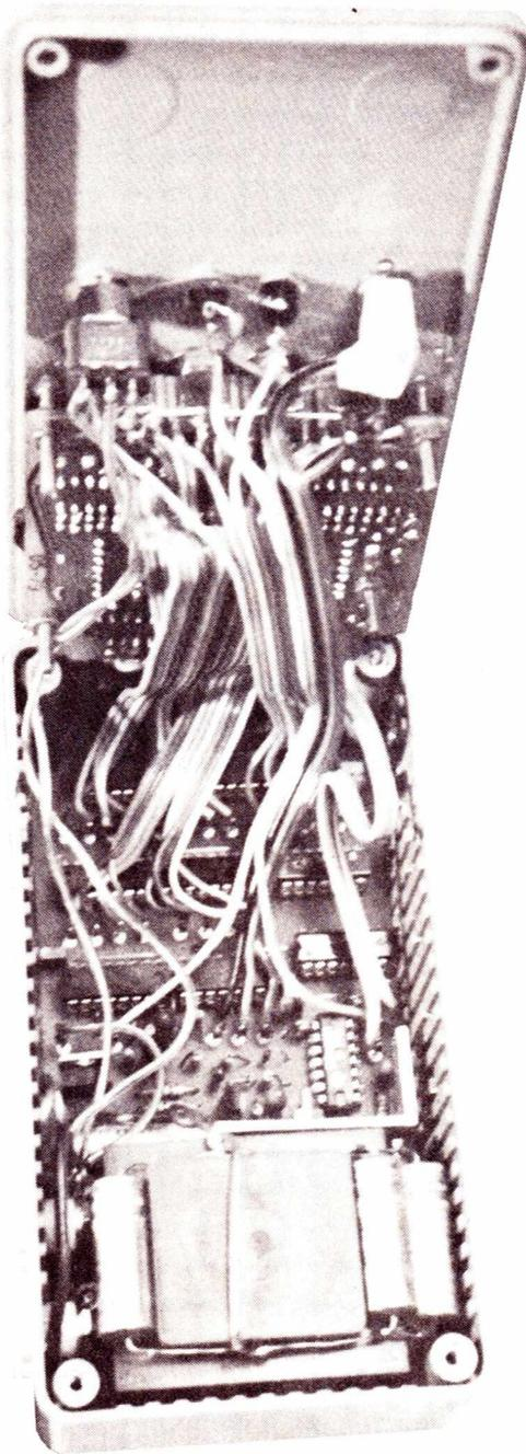
monter séparément les circuits d'affichage (IC<sub>1</sub> à IC<sub>5</sub> et AFF<sub>1</sub> à AFF<sub>4</sub>), et à les relier au reste du montage par un bus de méplat à 16 conducteurs (4 x 4 bits) et 2 fils d'alimentation de plus forte section (voir **photo 2**).
