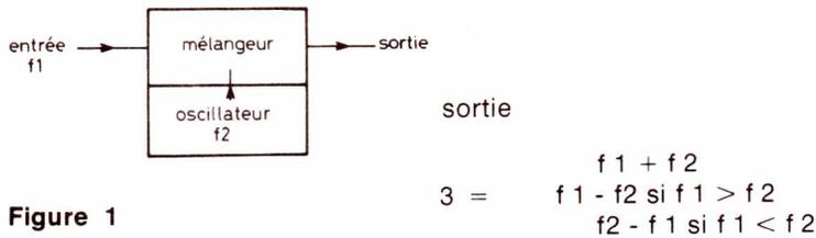
la sélection de  $f_3$  se fait par un circuit sélectif en sortie.
