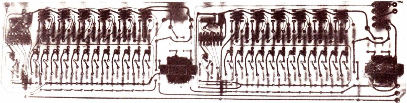
*Le circuit VU mètre. Les deux transformateurs ont été placés côté piste du circuit imprimé.*
