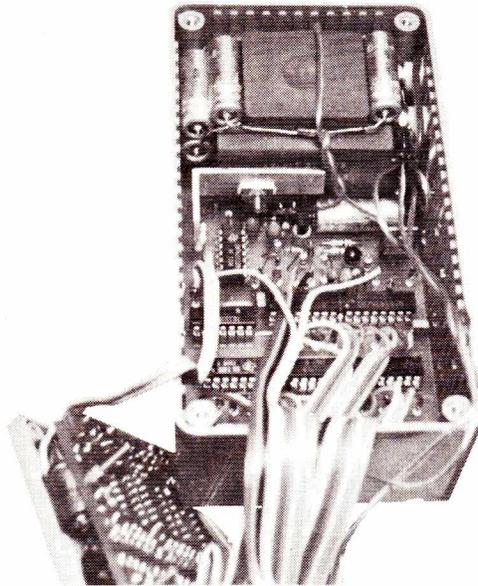
*Photo 4 : Deux des condensateurs de filtrage trouvent une place dans un espace situé sur le côté du transformateur. Dans la mesure de vos moyens, il faudra fabriquer un radiateur efficace pour IC9 que l'on enduira généreusement de graisse aux silicônes ou à l'oxyde de béryllium avant l'assemblage.*
