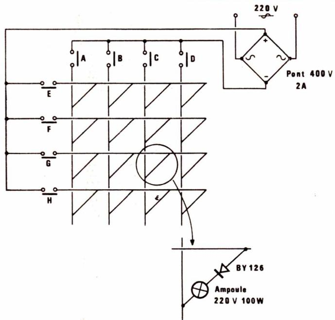
Figure 4 : Commande d'ampoules 220 V 100 W
