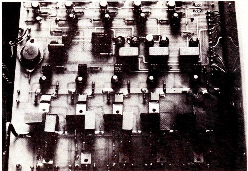
La carte principale de grande dimension reçoit une implantation très dense (près de deux cents composants). Les interconnexions avec les diverses commandes placées en face avant sont raccordées sur des picots soudés sur le circuit imprimé.
