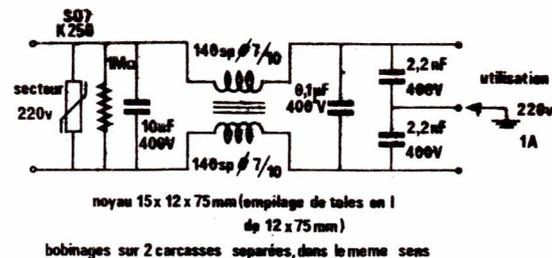
Figure 1 : Schéma de principe (noyau 15 x 12 x 75 mm, empilage de tôles en I de 12 x 75 mm, bobinage sur 2 carcasses séparées (dans le même sens).
