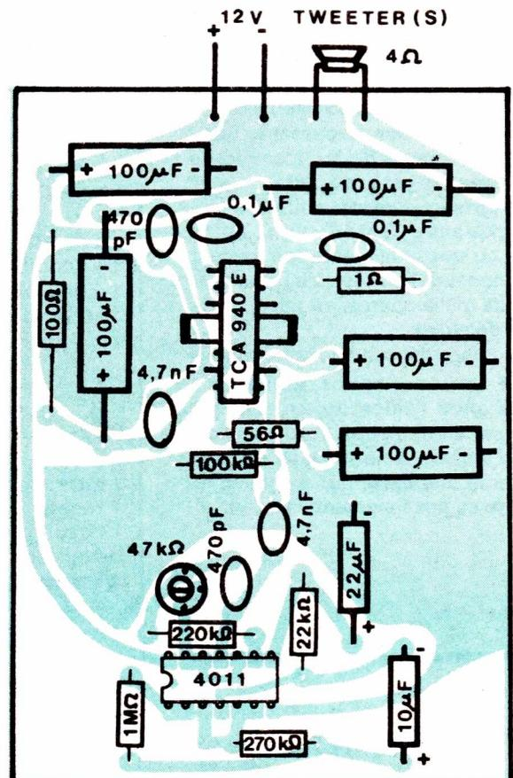
Figure 4 : Plan de câblage.
