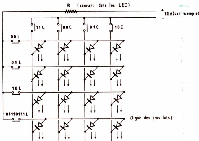
Figure 3 : Commande directe de 16 LED
