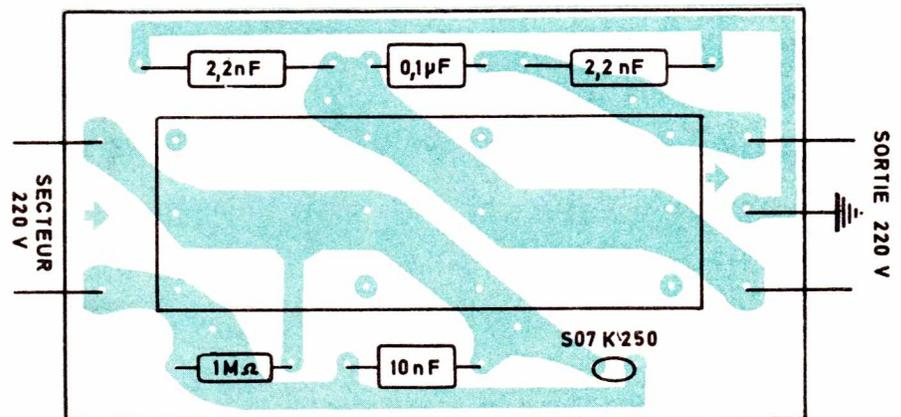
Figure 3 : Plan de câblage.
