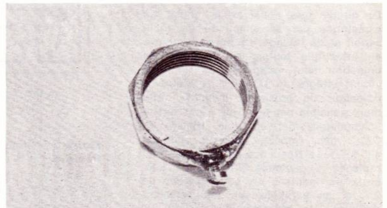
La bague de fixation du disque à secteurs sur l'arbre du distributeur (réalisée à partir d'un presse-étoupe en laiton).
