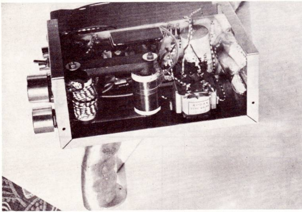
Vue de l'intérieur. Au premier plan à gauche, le transfo HT, primaire à gauche, secondaire à droite.
