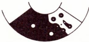
Figure 4 : Le circuit imprimé à monter dans le delco (modèle SEV).
