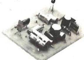
L'appareil permet de parler et d'écouter la conversation téléphonique avec les moins de frais, idéal pour les conversations commerciales et familiales. Le Kit comprenant un circuit intégré + un transistor.
