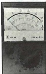
20000 ohms/V en continu, 4000 ohms/V en alternatif - Classe 2,5 - 5 fonctions :
