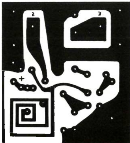
Figure 8 : Circuit imprimé préamplificateur FM.
