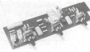
**CX7 - Amplificateur 7 W Musique.** Entrée 200 mV. Cellule piézo. Sortie 4-8 Ω. Alimentation 12-18 V. Double correction de tonalité. Montage Baxandall. Fusible de protection. Redresseurs et filtrage inclus.
