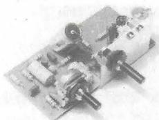
**CX2 - Amplificateur 3 W Musique.** Entrée 200 mV. Cellule piézo. Sortie 4-8 Ω. Alimentation 12-18 V. Correction de tonalité. Redresseurs et filtrage inclus.
