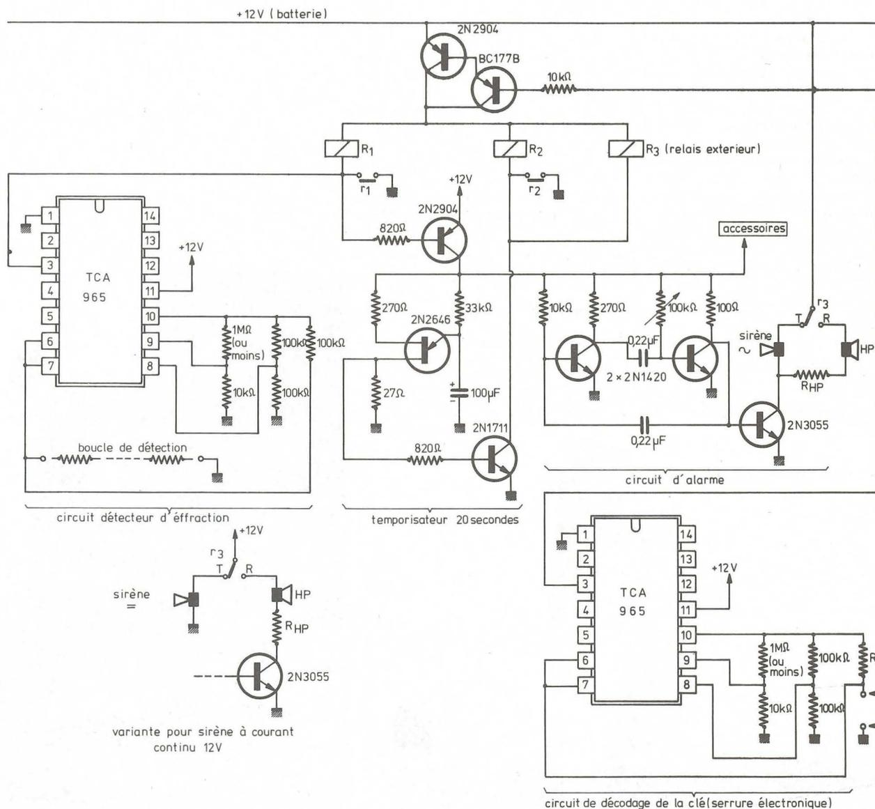
Figure 3 : le schéma de principe complet.
