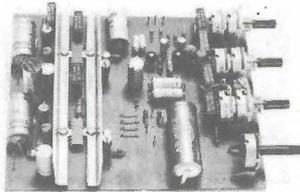
**EN KIT : AMPLIS TSM 10 transistors.** Entrée 800 mV - 15 Hz à 100 kHz. Puissance en W musique. Sortie 4 à 8 Ω. Câbles + 20 %.
