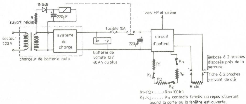
Figure 7 : schéma d'installation.
