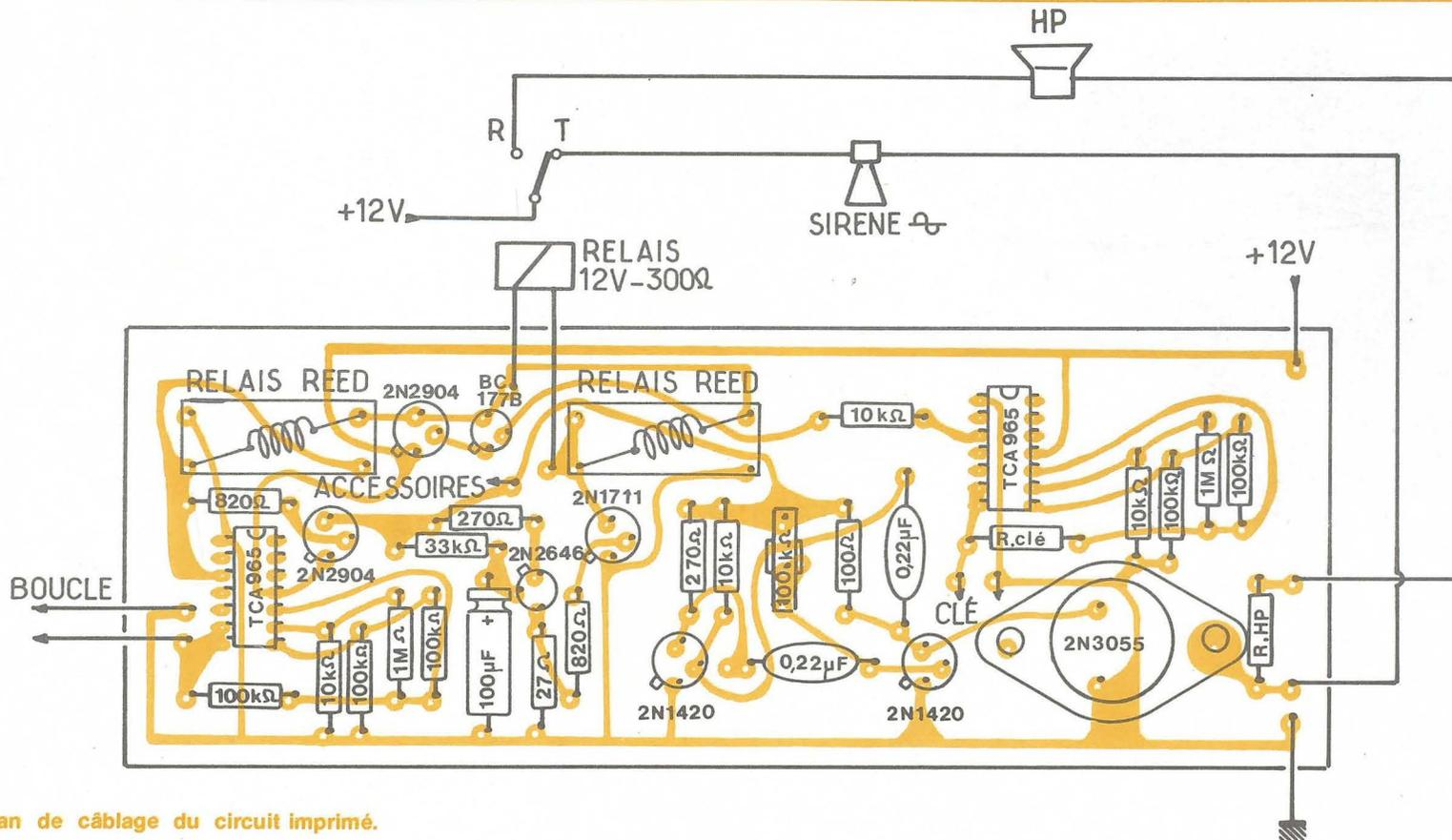
Figure 6 : plan de câblage du circuit imprimé.
