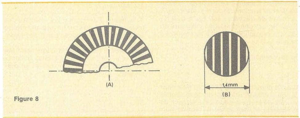
On a adopté le principe suivant : le parcours du rayon infrarouge est interrompu par les « rayons » opaques tracés sur un disque tournant.
