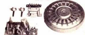
5 transistors, contrôle de volume et tonalité, entrée pour toutes cellules cristal (grâce à un adaptateur spéc. d'impédance), haut-parleur 17 cm Inversé, alimentation conjointe en 220 volts. Livré en pièces détachées, à monter par vous-mêmes selon schéma fourni.
