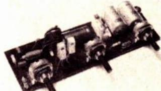
CX6 - Amplificateur 5 W musique. Entrée 200 mV. Cellule piézo. Sortie 4-8 Ω. Alimentation 12-18 V. Double correction de tonalité. Fusible de protection. Redresseurs et filtrage inclus.
