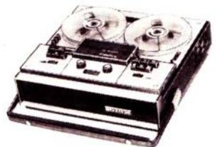
Réf. MC 30 - Magnétophone portable à bande, 4 pistes mono, vit. 2,38 - 4,75 - 9,5 cm/s, bobines 15 cm, ampli 4,5 watts, alim. 110/220 V - Entrées : micro (0,8 mV) - P.U. crist. (300 mV) - P.U. magn. ou tuner (1,6 mV) - Sortie auxil. et casque (0,8 V) - Dim. 315 x 300 x 120 mm.
