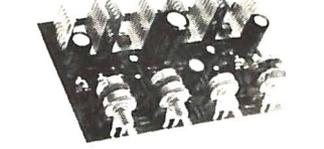
**MA 33 S.** Module ampli Hi-Fi stéréo 2 x 33 W. Sortie 8/16 O. Entrée 50 K Réponse 30-18000 Hz. Aliment. 2 x 28 V, 1 A. Réglages : Volume, basses, aigus (185 x 145 x 60).
