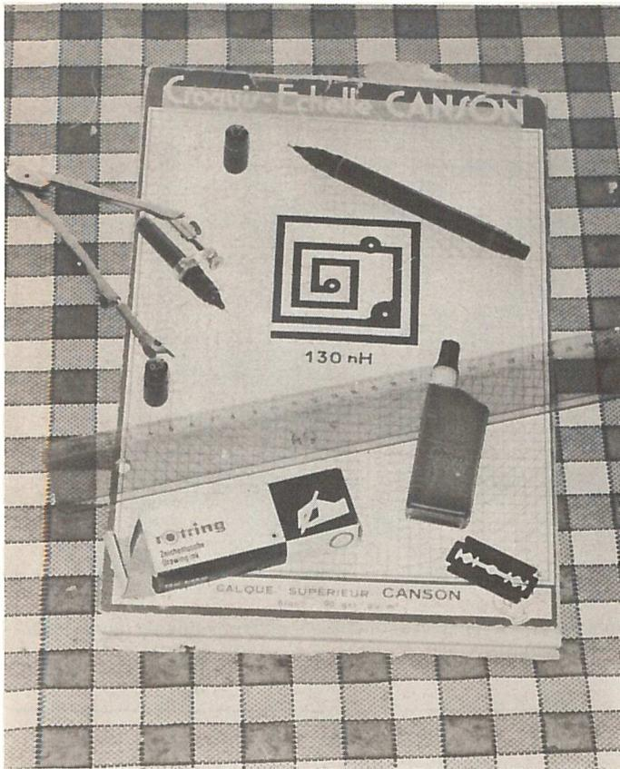
**2<sup>e</sup> opération :** Dessiner à l'échelle 4 le motif géométrique retenu à l'aide d'un instrument à encre de Chine. Ajouter les pastilles correspondant aux éventuelles prises.
