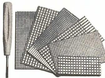
Plaquettes de stratifié de haute qualité réalisées par gravure mécanique de circuits conducteurs parallèles en cuivre. Coupeuse des bandes conductrices à l'aide d'un outil spécial
