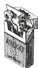
Emetteur miniaturisé réalisé sur une plaquette de circuit imprimé de 80x50 mm. Très grande facilité de montage. La parole émise peut être reçue sur la gamme F.M. d'un récepteur ordinaire. Le module obtenu peut être camouflé dans un étui à cigarettes de 80 x 55 x 25 mm, ou intégré dans un coffret plastique de mêmes dimensions. Portée de 30 à 40 m. Très sensible, retransmet tous les bruits et sons se produisant dans une pièce de dimensions courantes. Nombreuses applications.
