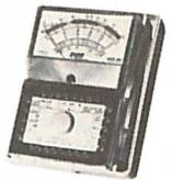
**VOC 20 : contrôleur universel 20 000 Ω/V**
