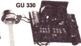
**GU 330 :** Trémolo électronique pour guitare électrique. Alimentation par piles (9 à 30 V). Adaptable également sur magnétophones et sur orgues ... 98,00 F
