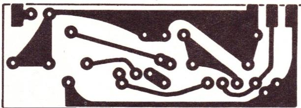
Figure 6 a : Circuit vu côté connexions
