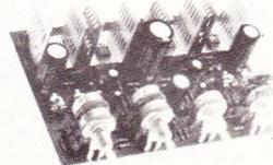
**MA 33 S** Module ampli HI-FI stéréo 2 x 33 W. Sortie 816 ohms. Entrée 50 K. Réponse 30 - 18 000 Hz Aliment. 2 x 28 V, 1 A. Réglages : Volume, basses, aigus (185 x 145 x 60). Frs ..... 190,00 - Franco ..... 198,00
