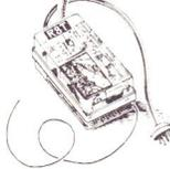
Récepteur à super-réaction : 27 MHz. Fonctionne sur réception d'une onde pure ou modulée en 27 MHz. Alimentation par pile 9 volts. Poids : 90 g. En coffret plastique de 90 x 55 x 35 mm.
