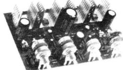
**MA 33 S** Module ampli Hi-Fi stéréo 2 x 33 W. Sortie 8/16 ohms. Entrée 50 K. Réponse 30 - 18 000 Hz. Aliment. 2 x 28 V, 1 A. Réglages : Volume, basses, aigus (185 x 145 x 60).
