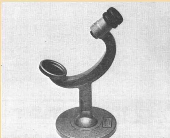
Le « Scoponet » est un dispositif de mise au point précis. L'image est reprise par un miroir, et cette image est examinée par un petit microscope. La mise au point se fait alors sur le grain de l'image.
