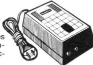
STOLLE 3406. Secteur 110/220 V. Sorties en courant continu stabilisé, commutable de 4-5-6-7, 5-9 et 12 V par transistor, puissance et diode Zener. Débit 400 mA. Protection secteur (120 x 75 x 50). Livré avec câble secteur.
