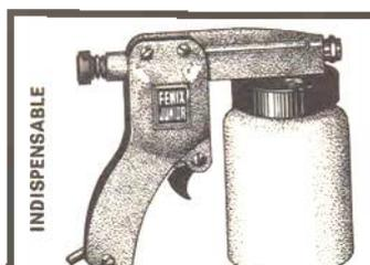
**FENIX** - Pistolet à peinture électrique 220 V. Permet de pulvériser toutes peintures, laques et vernis et tous produits liquides tels que pétrole, huile, xylophène, carbonyl, insecticide, etc. Fonctionnement à vibreur sans compresseur, donc sans air et sans brouillard. Garantie 6 mois. Livré avec gicleur 6/10. Accessoires optionnels sur demande
