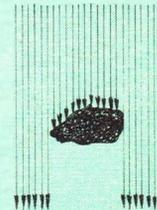
En lumière dirigée chaque grain s'interpose dans le faisceau cohérent de lumière et fait écran, sans réflexion et avec un minimum de diffraction.
