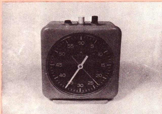
Un compte-secondes avec arrêt et remise à zéro, et comptant jusqu'à 60 minutes est un instrument indispensable dans un laboratoire photographique.
