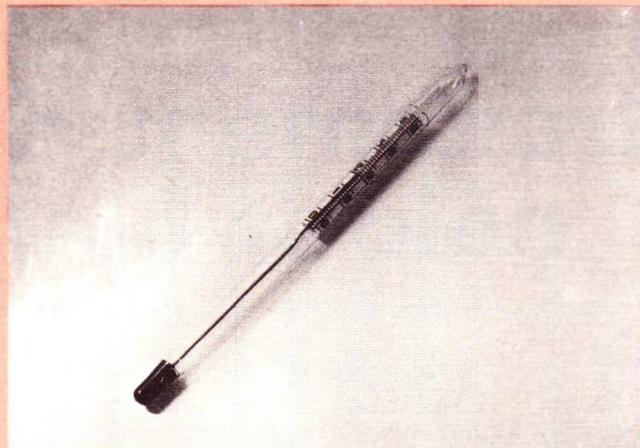
Un petit thermomètre à alcool, flottant, constitue le type de thermomètre le plus utile à avoir dans un laboratoire photo. La colonne teintée en bleu généralement, est visible, même à la lumière inactinique, et peut donc être utilisé, également, flottant sur la cuvette pour les tirages papier.
