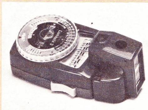
La Lunasix est sans aucun doute le posemètre, « pour amateurs » le plus « flexible » sur le marché. Avec un élément sensible au CdS, il a 2 échelles de sensibilités couvrant le rapport 1 à 2 000 000 (valeurs de l'illumination de 1 à 22)\* Le fabricant livre en accessoire un dispositif pour visée téléométrique (notre illustration) qui ramène l'angle de visée de 30° à 15° ou bien à 7,5°. Egalement intéressant, un « additif labor » qui en fait un posemètre d'agrandissement remarquable.
