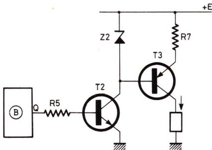
Fig. 6. — La sortie du bistable commande, par T<sub>2</sub>, le transistor T<sub>3</sub> qui fournit un courant constant dans son circuit collecteur (symbolisé ici par un rectangle) tant que le potentiel du collecteur de T<sub>2</sub> est inférieur à celui de son émetteur.
