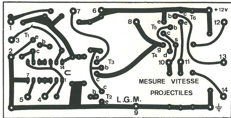
Fig. 11. — Dessin du circuit imprimé prévu pour recevoir le montage précédent, vu du côté du cuivre.
