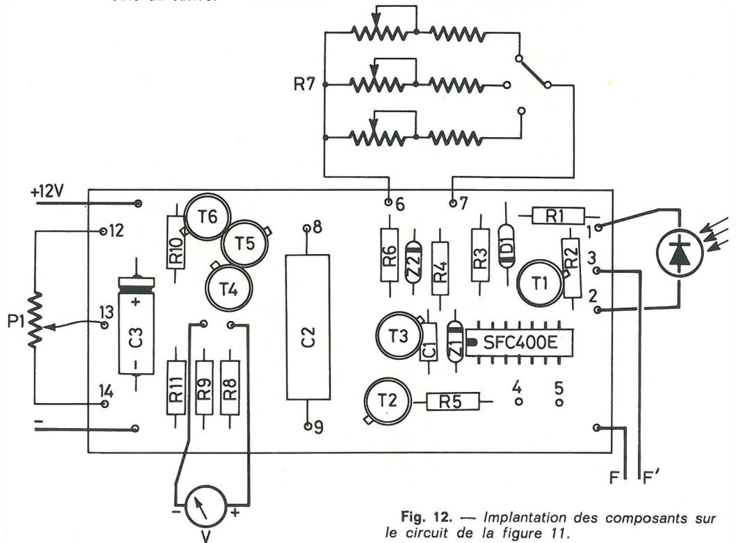
Fig. 12. — Implantation des composants sur le circuit de la figure 11.
