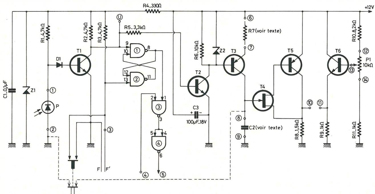
Fig. 10. — Schéma complet du montage. Les diodes Zener sont des BZX46C4V7, la photodiode  $P$  une 32F2 ou un phototransistor ESM 51 ou ESM 72 (base en l'air). Les transistors NPN  $T_1, T_2, T_6$  peuvent être des 2N1613, 2N1711, 2N2222, BC108A, ou tout transistor N-P-N supportant 12 V et ayant un gain de plus de 50 à 2 mA collecteur, fréquence de
