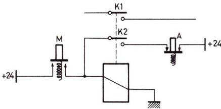
Fig. 5. — Le fonctionnement du montage basculeur bistable de la figure 4 est analogue à celui d'un relais auto-entretenu : une fois qu'on l'a fait coller par appui momentanément sur M, le contact K<sub>2</sub> maintient le bobinage du relais sous tension et il faut appuyer sur A pour faire re-décoller le relais.
