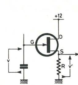
Fig. 7. — On peut mesurer la tension aux bornes d'un condensateur sans trop le décharger en utilisant un transistor à effet de champ monté en « source follover ».
