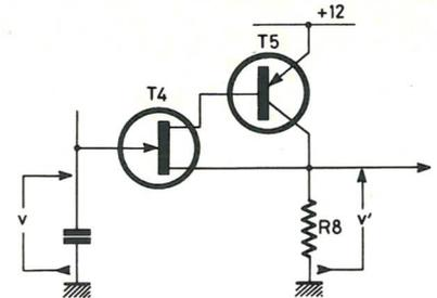
Fig. 8. — On améliore le montage de la figure 7 en remplaçant le seul F.E.T. par un ensemble F.E.T. + P.N.P. à contre-réaction totale.
