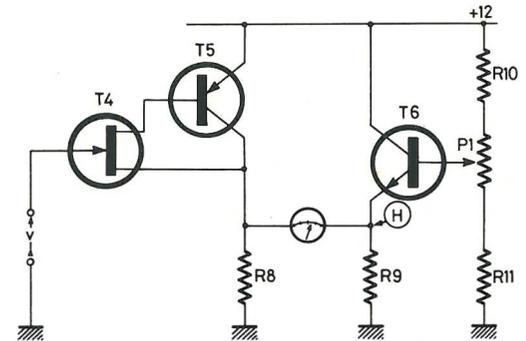
Fig. 9. — Comme le montage de la figure 8 introduit un décalage presque constant entre la tension  $v$  et la tension  $v'$  on compense ce décalage par la tension présente en H, sur l'émetteur d'un transistor monté en collecteur commun, dont le potentiel de base est commandé par un potentiomètre (réglage de zéro).
