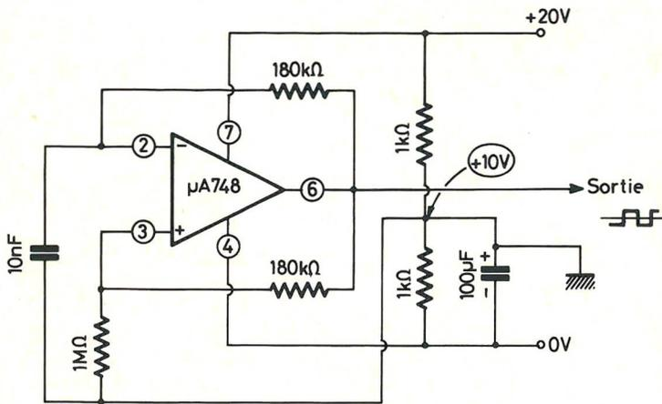
Ce montage utilise un amplificateur opérationnel intégré  $\mu A 748$ . Signalons que d'autres amplificateurs peuvent être utilisés, et notamment le  $\mu A 709$  qui a le même brochage, à la condition toutefois de brancher entre ses bornes 1 et 8 un condensateur de 10 à 30 pF pour limiter la bande passante.
