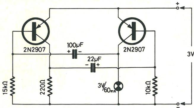
L'application la plus simple et que beaucoup ont réalisée est le clignotant simple dont voici un schéma utilisant des transistors PNP. Le principe est toujours le même et la lampe clignotante remplace une des résistances de charge des transistors. Le montage fonctionne sous 3 volts mais peut être utilisé également sous 4,5 volts à condition de changer l'ampoule, évidemment.
