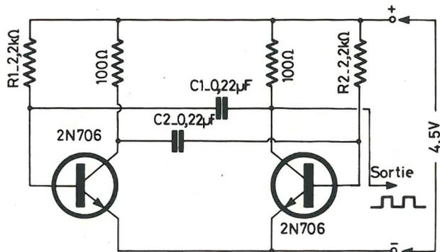
Voici pour commencer un multivibrateur du type « Abraham-Bloch » appliqué aux transistors. Ce montage fournit des signaux rectangulaires à une fréquence qui dépend des constantes de temps  $R_1 C_1$  et  $R_2 C_2$ . Dans le cas des valeurs du schéma, cette fréquence est d'environ 1 500 Hz. Les deux constantes de temps  $R_1 C_1$  et  $R_2 C_2$ , étant identiques le signal fourni est carré et l'on peut calculer la fréquence pour d'autres valeurs en appliquant la formule :
