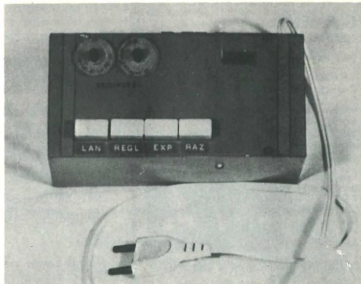
La touche REGL permet, pendant les réglages de cadrage et de diaphragme, de simuler les conditions d'exposition, tout en rendant inopérante (grâce au contact  $r_1$ ) toute impulsion sur EXP.
