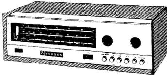
Tuner multi-gammes pour la réception en Hi-Fi des émissions radio AM-FM - Accord indépendants pour la FM et la AM - Décodeur spécial FM stéréo, basé sur le système à fréquence pilote - Indicateur lumineux d'émissions stéréo - Cinq gammes, commutation par boutons-poussoirs, GO de 150 à 380 kHz PO de 250 à 1 620 kHz sur antenne ferrite incorporée OC de 5,85 à 10 MHz - Ondes ultra-courtes FM de 87,5 à 180 MHz - Indicateur d'accord sur toutes les gammes A.F.C. commutable.
