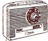
à piles 3 lampes et PUSH-PULL à 2 transistors. 2 gammes PO-GO. Coffret matière plastique. Présentation moderne.
