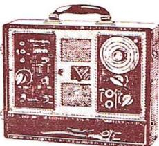
La Mire Portable 783 est destinée au dépannage extérieur, rend également à l'atelier d'inestimables services pour la vérification et la mise au point de tous les types de téléviseurs, pour tous les canaux des standards français, belges et européens à 625 ou 819 lignes.
