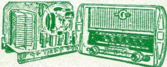
Châssis monté 6 lampes miniatures et Noval, super-alternatif 110-240 volts, œil magique, clavier 6 touches : PU - A - GO - PO - BE - OC. Cadre à air orientable. Dimensions : 365 x 165 x 220 mm. En ordre de marche, prix exceptionnel avec H.P..... **15.900**
