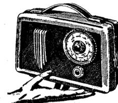
7 transistors + diode au germanium.
