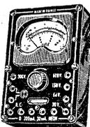
16 sensibilités : Volts continus : 0-30-60-150-300-600. Volts alternatifs : 0-30-60-150-300-600. Millis : 0-3Q-300 milliampères. Résistances de 50 à 100.000 ohms. Condensateurs de 50.000 cm à 5 microfarads. Livré complet avec cordons et mode d'emploi.
