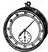
(marque « FOUCHE »), compte secondes 1 minute par tour de cadran. Départ et arrêt instantanés par bouton poussoir. Il comporte un 2<sup>e</sup> cadran totalisateur de minutes. Remise à 0 instantanée des cadrans secondes et minutes. Diamètre : 115 mm. Epaisseur : 60 mm. Prix..... **3.000**
