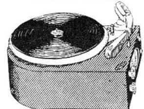
ELECTROPHONE équipé d'une platine « COLLARO » 3 vitesses montée sur socle 33-48-78 tours. Fonctionne sur 110 et 220 volts alternatif. Bouton de tonalité, grave et aiguë. Bouton de puissance. Deux saphirs réversibles. Musicalité parfaite.
