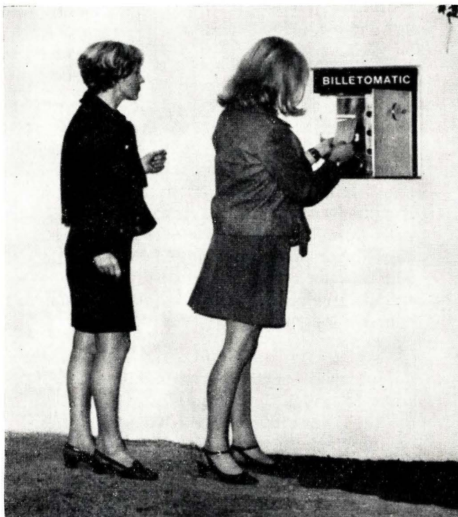
Le distributeur de billets de banque, « Billetomatic » est d'une grande commodité d'emploi ; il permet aux titulaires d'un compte bancaire de s'approvisionner en coupures, à toute heure du jour et de la nuit.
