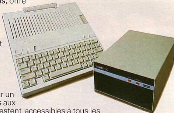
**Symbfile** – Ce sont des disques durs utilisant la technologie Winchester, réputée pour sa fiabilité. Ils sont compatibles avec les derniers nés de chez Apple: **Macintosh** et **Apple IIc** ainsi qu'avec **Apple III**, **Apple IIe** et **Apple II+**. Ils sont disponibles en capacité maximum de 42 mégaoctets (permettant de sauvegarder jusqu'à 25,000 pages de textes).
