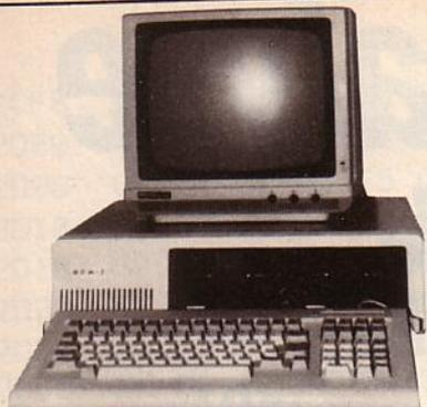
**HDM-I** compatible II+ 64 K, 6502, ventilateur, clavier dét. avec fonctions, moniteur 12", 2 drives, boot rom.
