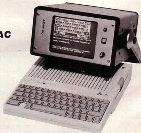
L'écran portable pour l'Apple IIc haute définition avec batterie intégrée permettant d'alimenter en autonome l'écran et l'Apple pendant plus de 4 heures.
