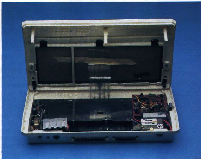
La carte électronique est protégée par un dissipateur de chaleur.
