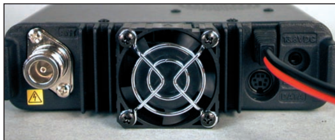
4 - Le panneau arrière, notez le connecteur antenne de type N.
