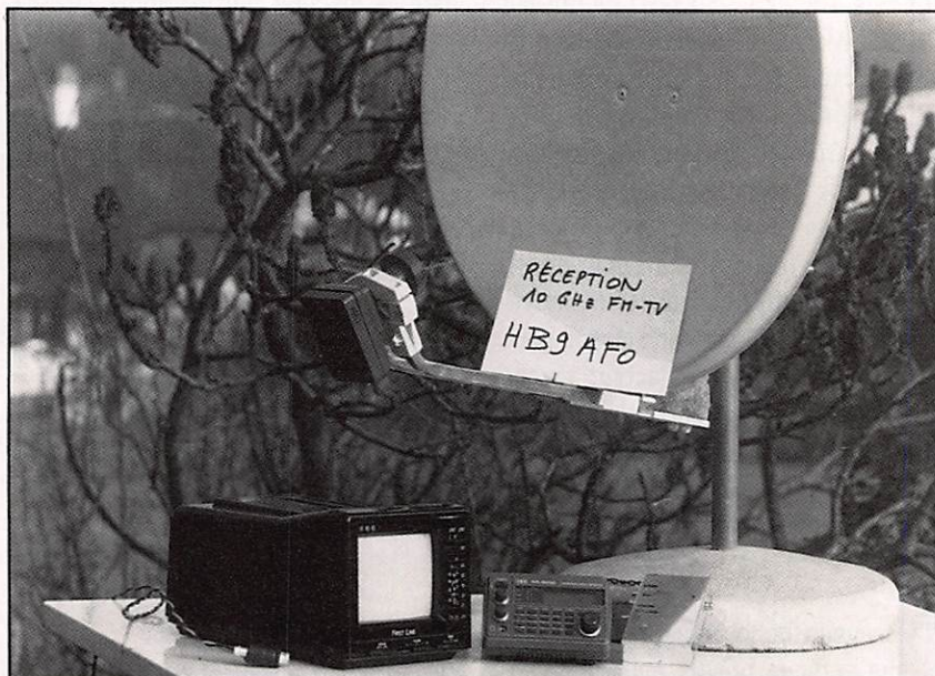
L'ensemble de réception 10 GHz complet.
