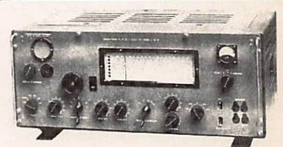
**RÉCEPTEUR DE TRAFIC AME 7G-1680**. Superhétérodyne à double changement de fréquence, couvre de 1,7 à 40 MHz en 7 gammes, sensibilité 1 µV. Alim. secteur 110/220 V, HP incorporé.
