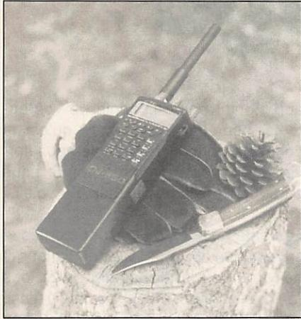
gammas couvertes sont celles des bandes 2 mètres et 70 centimètres. Le pas peut être choisi de 5, 10, 12,5, 20 ou 25 kHz. Le 1750 est incorporé. Il
