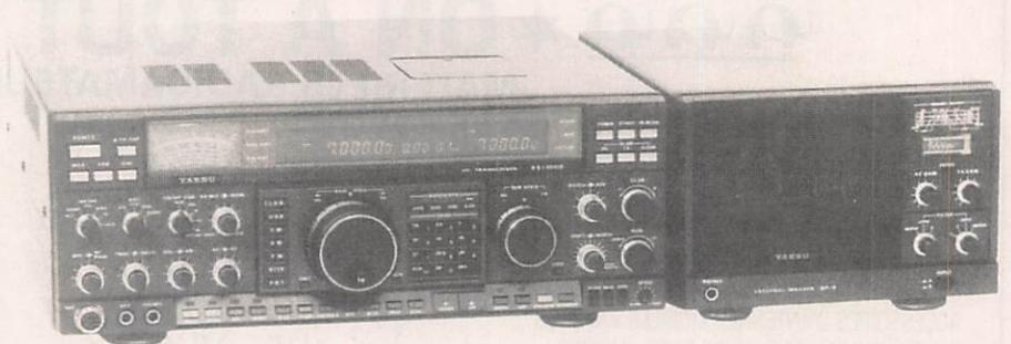
L'utilisation en split est facilitée avec l'apparition du second récepteur interne permettant, dans une même portion de 500 kHz, d'écouter deux stations sur des fréquences différentes avec la commande DUAL. La boîte d'accord à réglage rapide, particulièrement efficace, est utilisable avec 39 mémoires.
