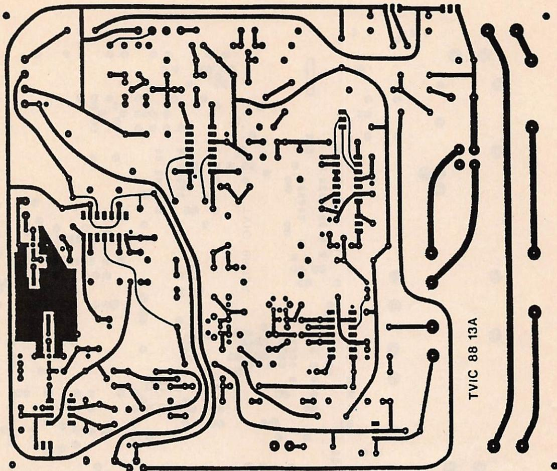
Figure 2 : Le circuit imprimé côté pistes, échelle 2/3
