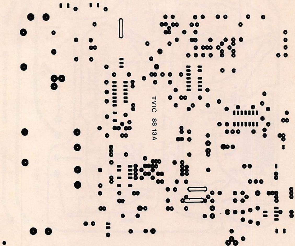
*Figure 3 : Le circuit imprimé côté composants, échelle 2/3*
