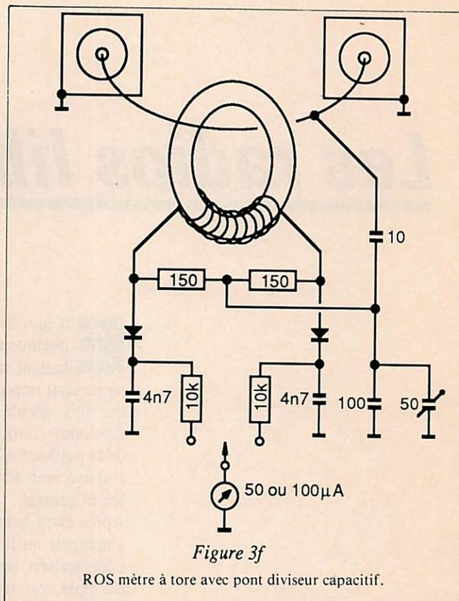
A puissance traversante égale, ces ROS mètres fournissent des tensions détectées d'autant plus élevées que la fréquence est grande, ils doivent sur les bandes basses, être traversés par des puissances relativement importantes pour donner des déviations significatives.
