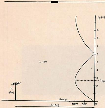
Tension détectée en fonction de la hauteur du contrôleur de champ  $\lambda = 2$  m,  $d = 10$  m, antenne d'émission à 2 m de haut.
