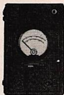
Très beau contrôleur, toujours en service dans l'armée US - Continu 2000  $\Omega$  volt de 0 à 5000 V et de 250  $\mu$ A à 10 A - Alternatif 1000  $\Omega$ /volt de 0 à 1000 V - Ohmmètre 5 gammes de 0 à 10 Megohms - Avec notice - Coffret alu coulé de 28 x 18 x 11 cm avec couvercle - Poids 6 kg. Prix **285 F**
