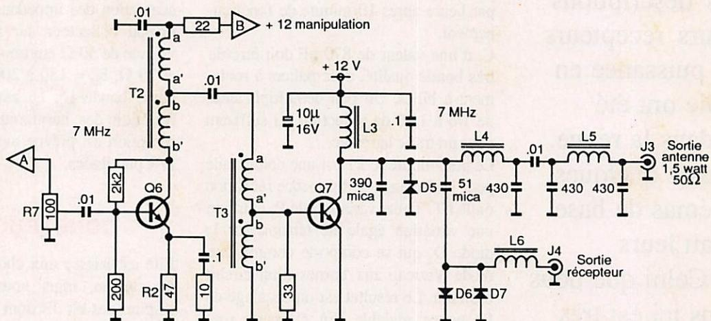
Figure 2 : Driver et ampli de puissance 1,5 W HF
