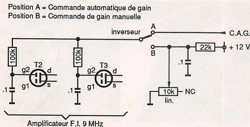
Figure 1 : Commande manuelle de gain HF
