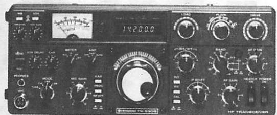
Émetteur-récepteur HF TS 530 Sp Émission réception. Bandes amateurs. SSB/CW. Alimentation secteur incorporée.
