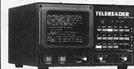
**TELEREADER CWR 675.** Décodeur RTTY / CW / ASCII. Moniteur 5 pouces incorporé.
