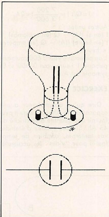
Si l'on place dans la cuve une solution chimique (solution d'acide chlorhydrique), si les électrodes sont en platine (vous comprenez pourquoi on ne fait pas l'expérience !) et si on fait passer du courant électrique, on voit apparaître des bulles sur les électrodes, du chlore sur l'une, de l'hydrogène sur l'autre. Ces apparitions de gaz, dues au passage du courant constituent l'effet chimique du courant électrique. A noter que la solution mise dans l'électrolyseur est appelée l'ELECTROLYTE.
