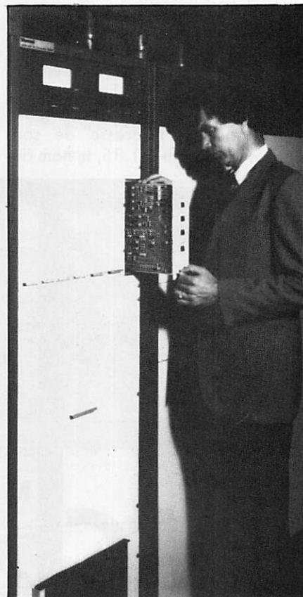
Nouvelle génération d'émetteurs TV récemment annoncée par Marconi. La série B7500 comprend des puissances de 1 kW à 25 kW pour la Bande III (174-225 MHz).
