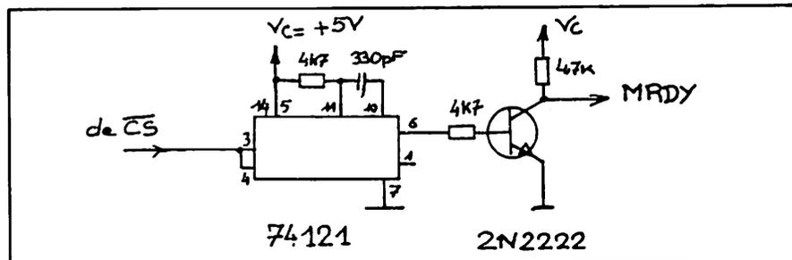
Figure 5 — Ralentisseur d'horloge
