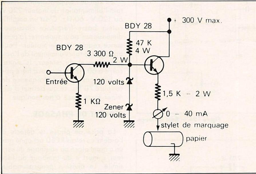
Figure 13 — Amplificateur de commande du fac-similé « BCR 4500 ».
