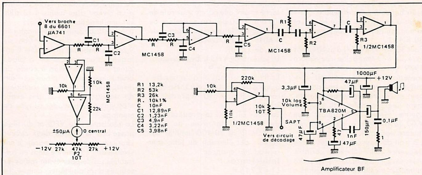
Figure 11 — Amplificateur BF de filtre passe-bande.
