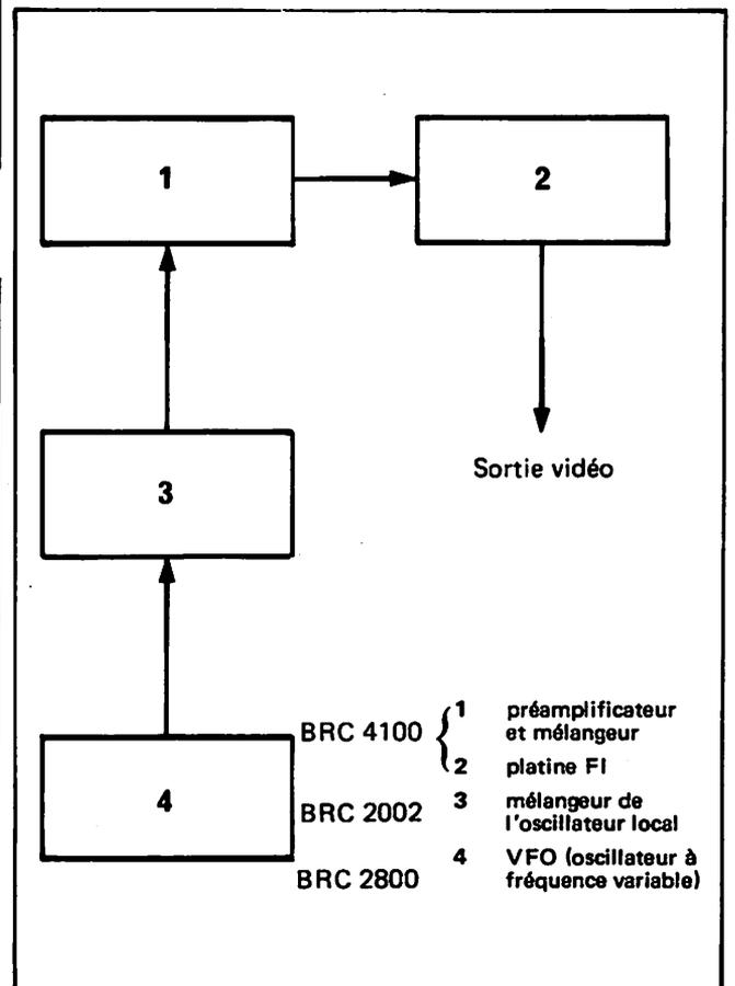
Figure 4 — Récepteur UHF schéma bloc.
