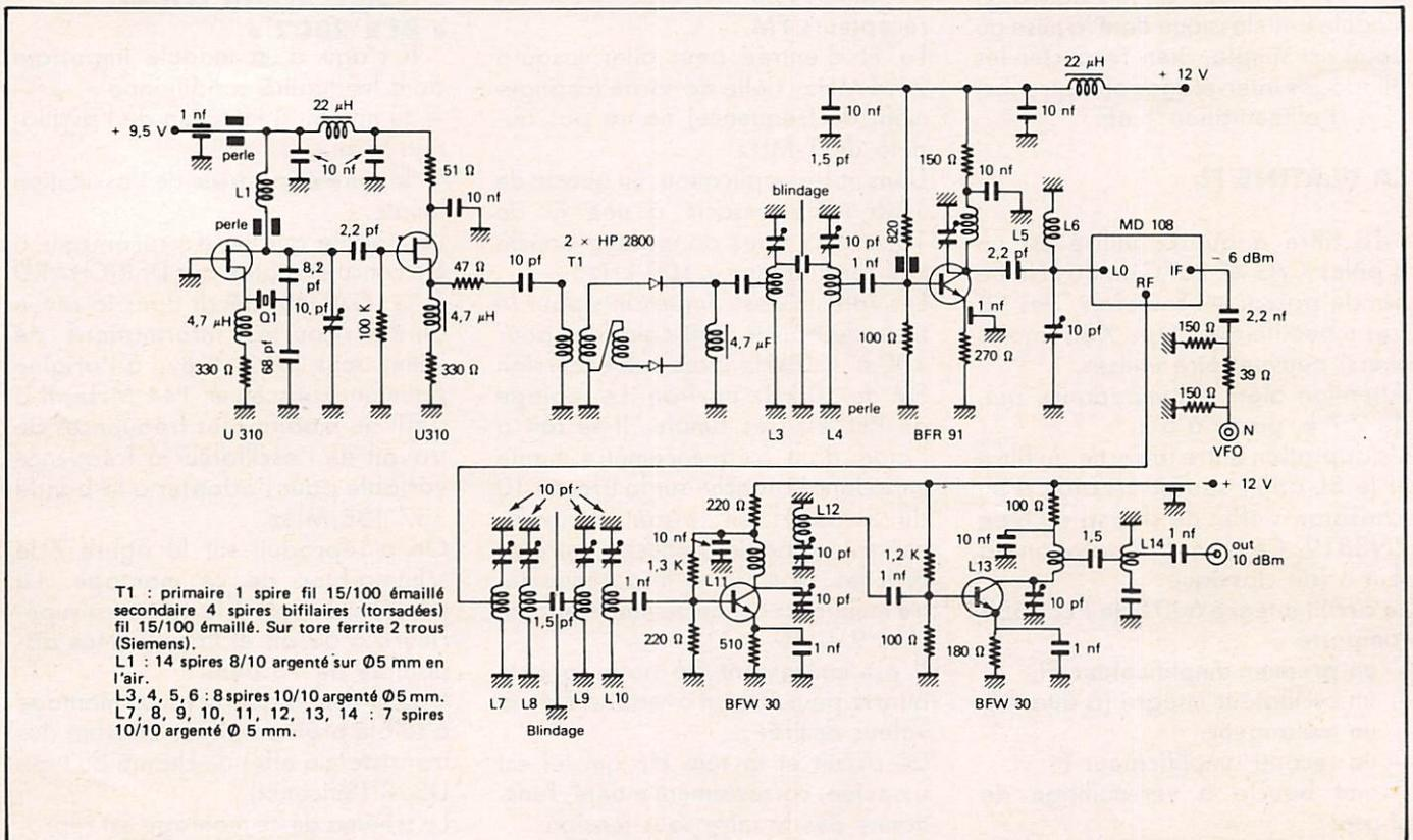
Figure 8 — Schéma du mélangeur de l'oscillateur local (F1FHR).
