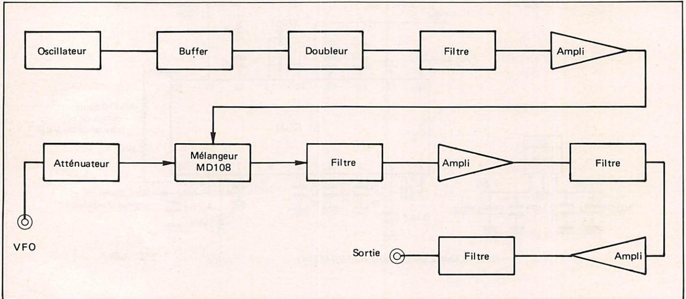
Figure 7 — Schéma - Bloc - Mélangeur de l'oscillateur local.
