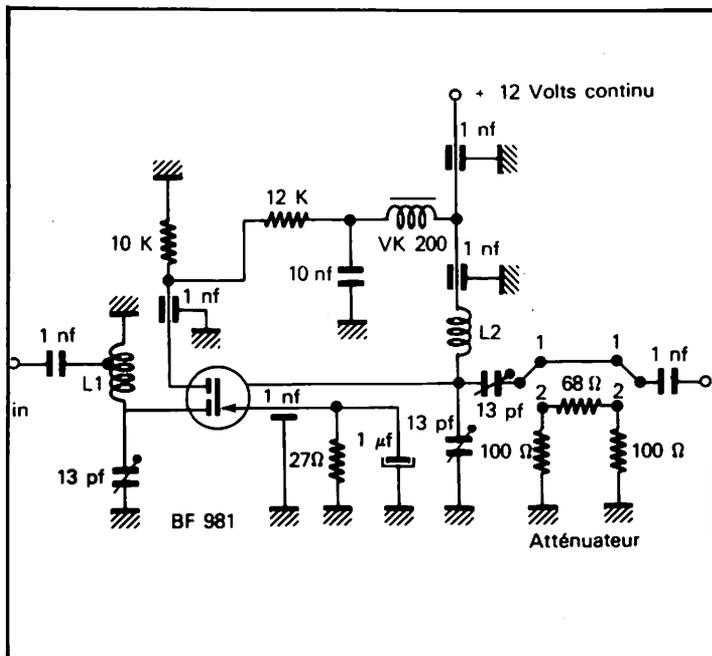
Figure 3 — Preamplificateur VHF type-SSB « SV 1440 » propriété SSB.
