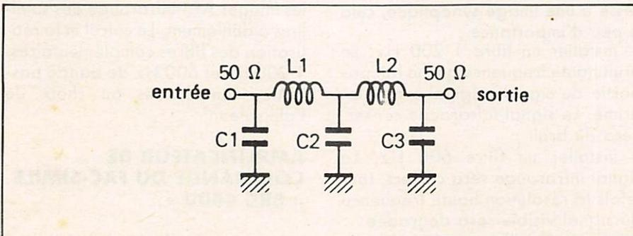
Figure 10 — Filtre passe-bas (F<sub>c</sub> égal 6 MHz).
