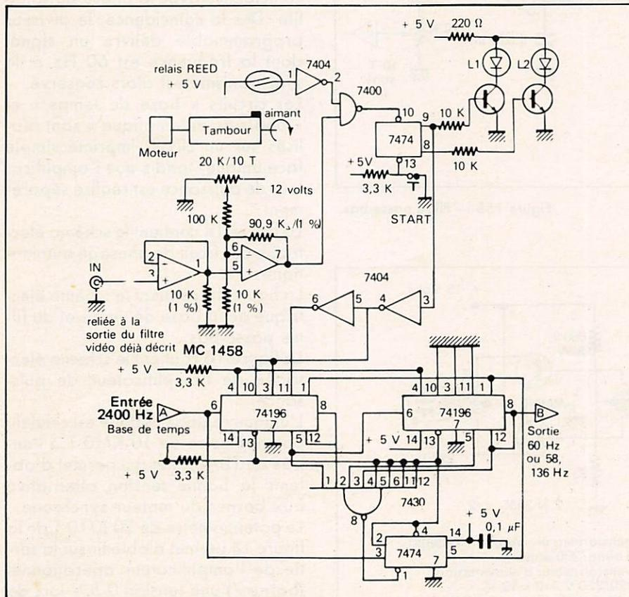
Figure 14 — Circuit de prise de phase.
